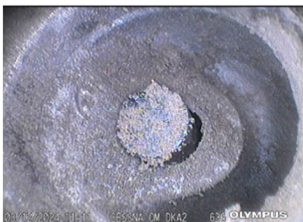
Detailní pohledy na stav výfukového ventilu ve válci č. 2
