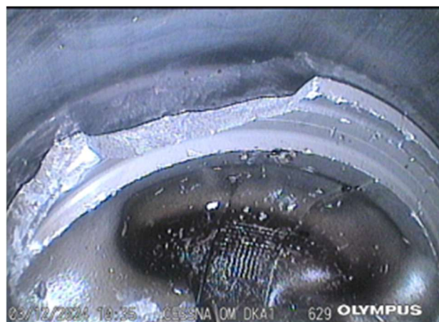
Detail praskliny na spodní straně pístu ve válci č. 1
