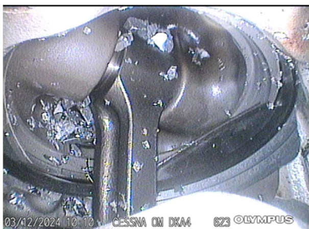
Stav ojnice, pístu a kovových úlomků ve válci č. 4
