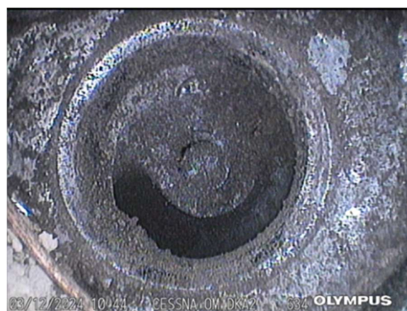
Detailní pohledy na stav výfukového ventilu ve válci č. 2
