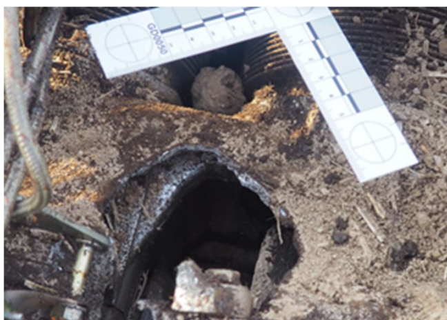
Obr. 8 – Proražený otvor v horní straně tělesa skříně motoru
