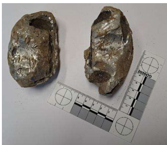
Obr. 9 – Deformované části pístu z motoru
