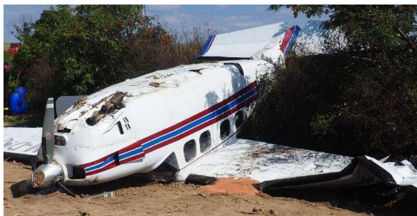
Obr. 7 – Stav letounu Cessna P210N po nouzovém přistání a převrácení
