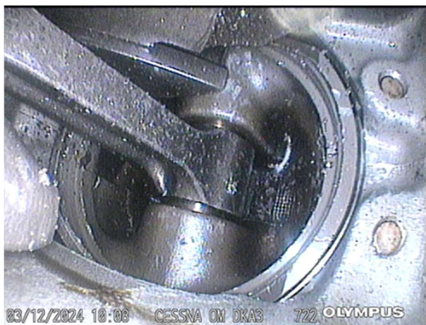
Stav ojnice a pístu v místě pístního čepu ve válci č. 3
