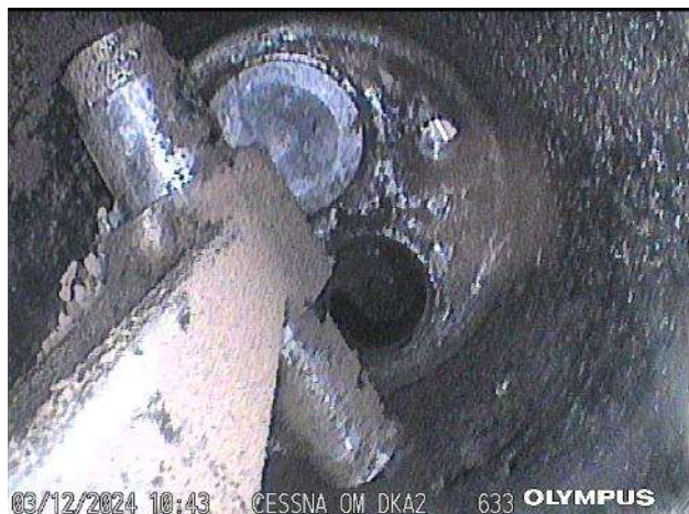
Obr. 10 – Chybějící hlava výfukového ventilu a píst ve válci č. 2
