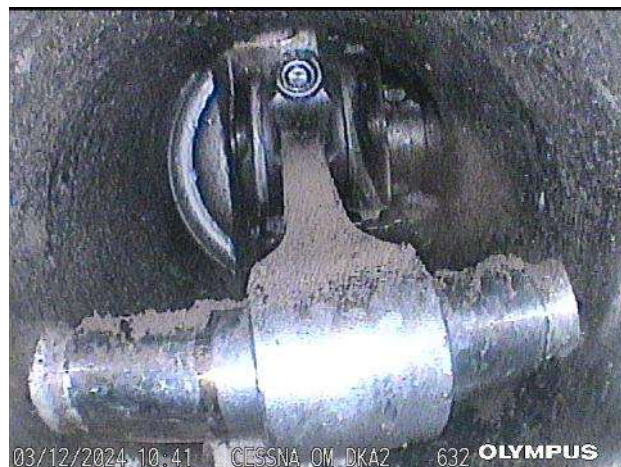
Obr. 10 – Chybějící hlava výfukového ventilu a píst ve válci č. 2
