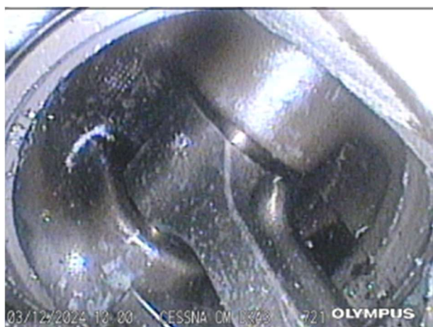
Stav ojnice a pístu v místě pístního čepu ve válci č. 3
