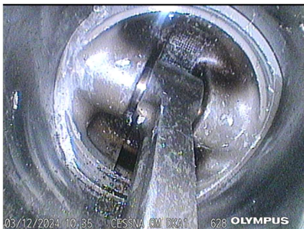
Stav ojnice a spodní strany pístu ve válci č. 1
